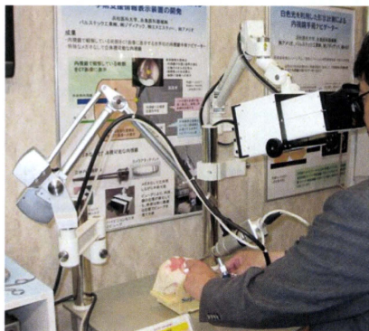
図2 表示支援機構、支持機構の製作による内視鏡の顕微鏡化
