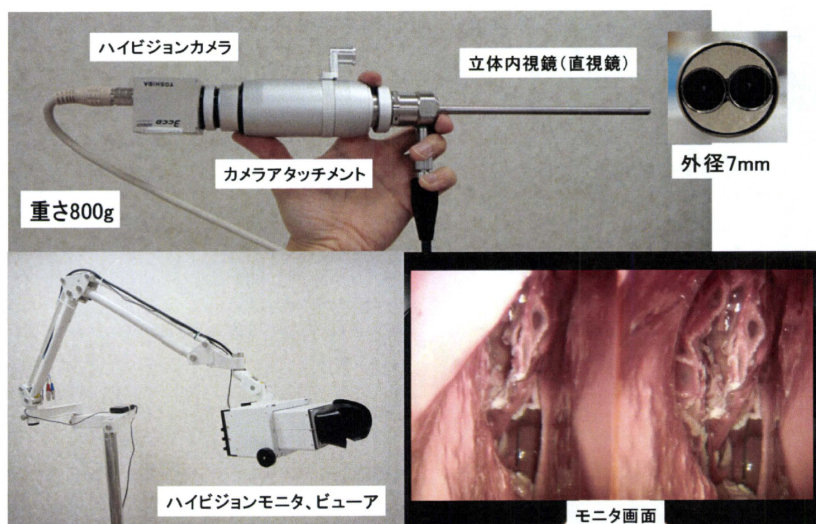
図1 片手で内視鏡本体を把持して手術することを想定した JST 事業試作立体内視鏡 外径7mmの内視鏡鏡筒にカメラアタッチメントを介してハイビジョンカメラを取り付け内視鏡像を撮影し、ビューアにハイビジョン画像を表示するので、モニター画面を見て立体視しながら（常に内視鏡の位置に合わせて術者が無理な姿勢をとることなく）手術しやすいポジションを取れる。
