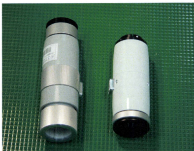
図 4 通常のカメラアタッチメント（右）と顕微鏡のズーム・フォーカス機能を導入したカメラアタッチメント（左）
