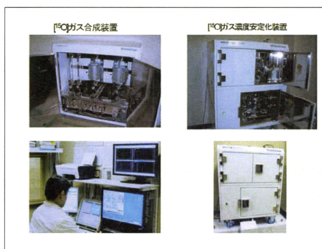
第2図 医療機器申請を前提に製造された迅速ガスPET対応型の ^{15}\text{O} -標識ガス自動合成・供給システムの外観。
