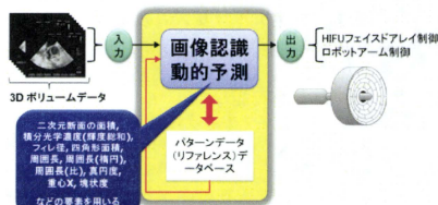
Fig. 3 遅延の補償を含めた、3D超音波ボリュームデータのリアルタイム解析によるHIFU照射制御。
