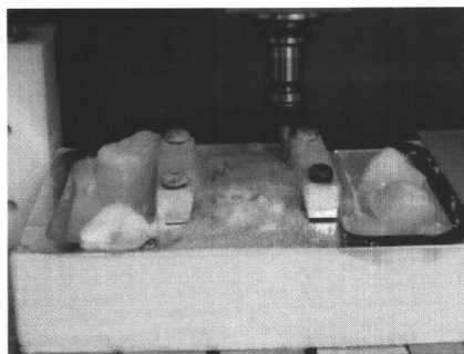
図 33 : NC 加工機による SPU 多孔体の切削
