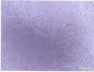
図 17-C. シミュレーション試験 300 万回後の R_a = 0.06 \mu\text{m} の Co-Cr 骨頭と対向した未処理 CLPE ライナー摺動面の LSM 像
