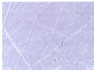
図 20-E. 300 万回後の Ra = 0.04 \mu\text{m} の Co-Cr 骨頭の SEM 写真 (対向: PMPC 処理 CLPE)
