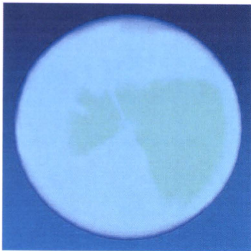
図 18-F. シミュレーション試験 300 万回後の Ra = 0.06 \mu\text{m} の Co-Cr 骨頭と対向した PMPC 処理 CLPE ライナーの摺動面コンター図
