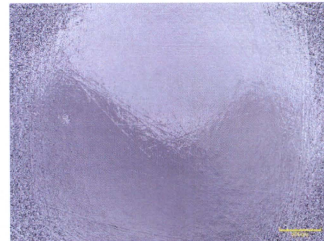
図 17-B. シミュレーション試験 300 万回後の Ra = 0.04 \mu\text{m} の Co-Cr 骨頭と対向した未処理 CLPE ライナー摺動面の LSM 像
