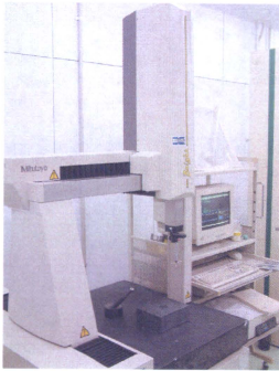
図 4. ミツトヨ製 CNC 三次元測定器
