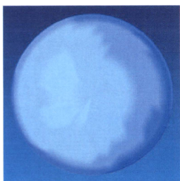
図 18-A. シミュレーション試験 300 万回後の Ra = 0.02 \mu\text{m} の Co-Cr 骨頭と対向した未処理 CLPE ライナーの摺動面コンター図
