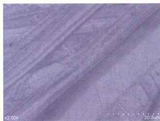
図 14-B. 試験前の Co-Cr 骨頭 (40 mm) 表面の SEM 写真
