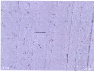
図 15-C. 1000 万回後の 40 mm Al 2 O 3 骨頭表面の SEM 写真 (対向：未処理 CLPE)
