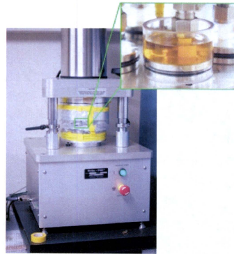
図 2. pin-on-disk 型摩耗試験装置 (AMTI 製 Ortho-POD)
