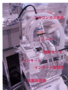
図 1-2. PMPC 処理装置 (処理槽拡大)
