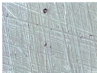
図 15-B. 300 万回後の R_a = 0.04 \mu\text{m} の Co-Cr 骨頭の SEM 写真 (対向: 未処理 CLPE)
