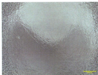
図 8-B. 300 万回後の R_a = 0.04 \mu\text{m} の Co-Cr 骨頭と対向した未処理 CLPE ライナー摺動面の LSM 像
