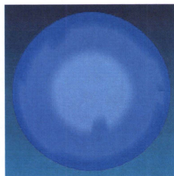
図 13-A. 300 万回後の Ra = 0.02 \mu\text{m} の Co-Cr 骨頭と対向した PMPC 処理 CLPE ライナーの摺動面コンター図
