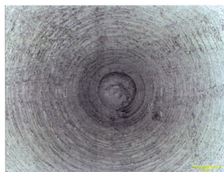
図 7-B. 試験前の PMPC 処理 CLPE ライナー摺動面の LSM 像
