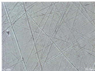
図 15-A. 300 万回後の R_a = 0.02 \mu\text{m} の Co-Cr 骨頭の SEM 写真 (対向: 未処理 CLPE)
