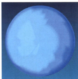
図 12-A. 300 万回後の Ra = 0.02 \mu\text{m} の Co-Cr 骨頭と対向した未処理 CLPE ライナーの摺動面コンター図
