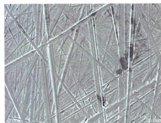
図 15-C. 300 万回後の R_a = 0.06 \mu\text{m} の Co-Cr 骨頭の SEM 写真 (対向: 未処理 CLPE)
