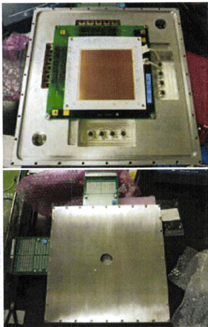
図 8 図 7 のセットアップをガス封切容器に取り付けた様子。
