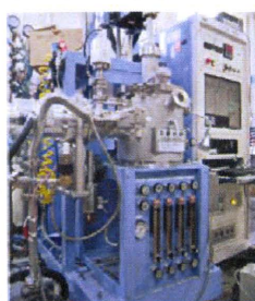
図 1. フッ化物バルク結晶育成に用いたチャンバー型 Cz 法の上)概念図および(下)実際の装置の概観。
