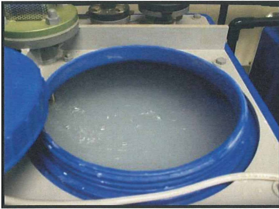
写真1 国立保健医療科学院浄水実験プラント 原水調製槽（原水濁度：300度）
