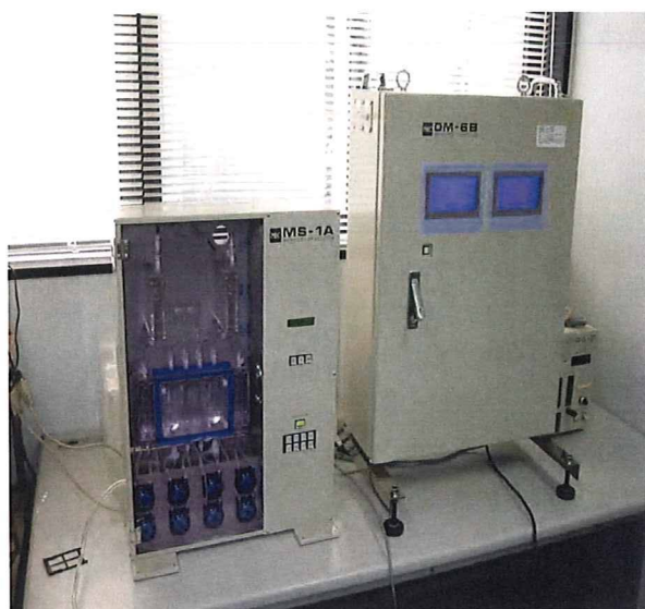
図 B.2.1 形態別水銀湿式連続分析計
