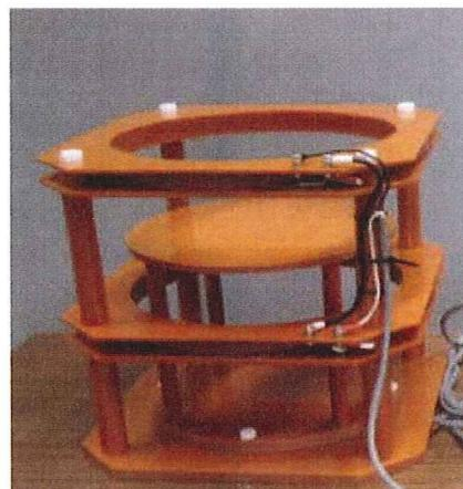
磁界発生装置（全ての細胞および動物の実験に使用）
