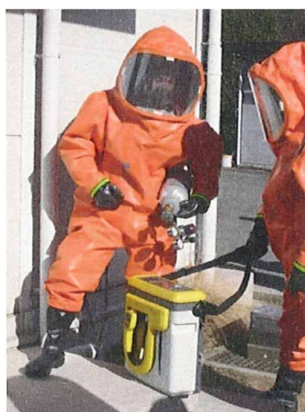
携帯型 GC/MS を用いての検知
