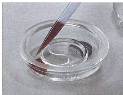
図② 外室の一方に血液試料を入れる
