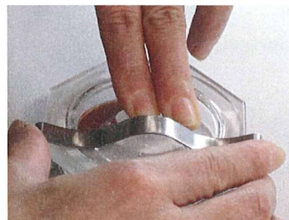
図④ グリセリンを塗布した蓋で密閉し血液試料と硫酸を混和する
