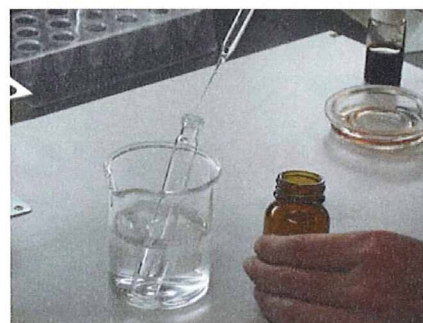
図⑥ クロラミンT試液、ピリジン・ピラズロン試液を加えて発色させる
