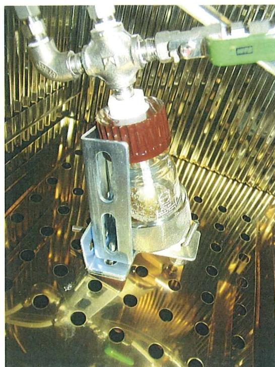
図3 クロロピリフォスの発生容器 (50℃に加温した恒温槽内に設置)
