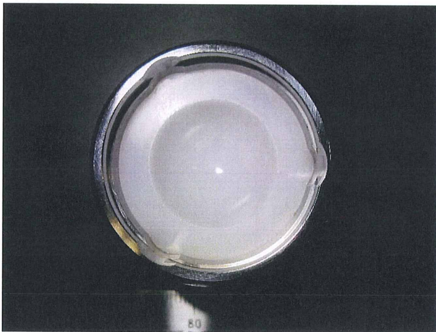
図 1 3 OUH009 のアウターカップと UHMWPE ライナー。摺動面には光沢が見られる。
