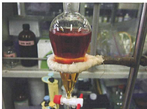
Figure 20: : 酸性条件下でタマネギ外皮抽出液から色素を n -ブタノール層へ抽出した様子。
