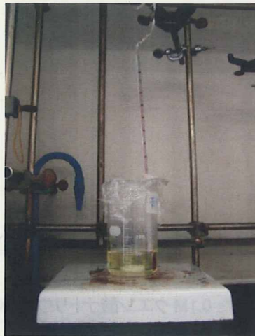
Figure C-1. 金ナノ粒子合成装置
