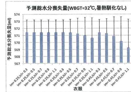
図 6-16. 各種衣服条件での予測総水分喪失量 (WBGT=32°C, 中代謝量, 暑熱順化なし)
