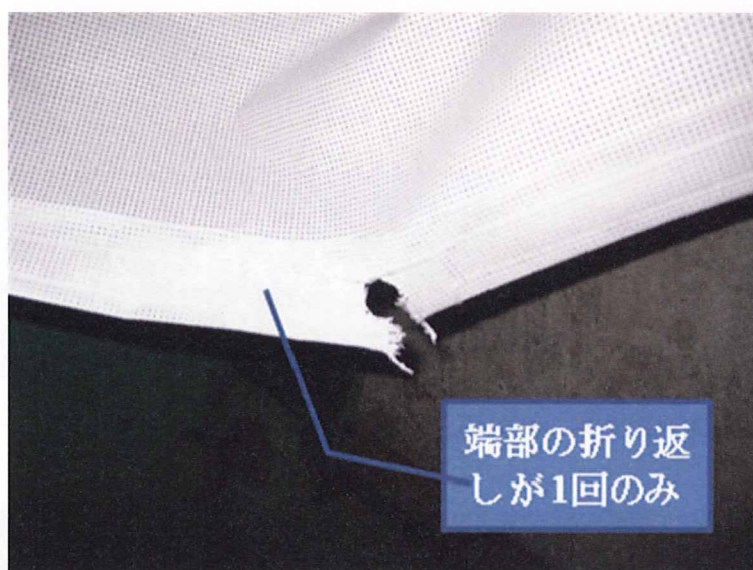
写真3. 落体の墜落の衝撃で脱落したハトメ部分 （昨年度の実験結果）
