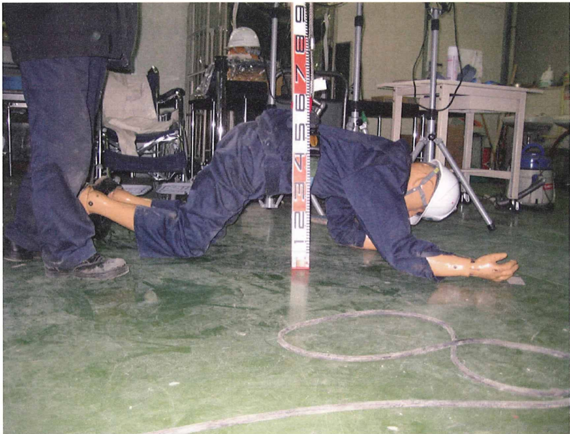
写真 6. 実験に用いた人体ダミーの落下姿勢
