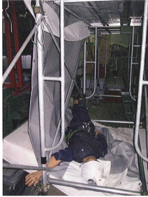
写真 12. 実験 2 の実験後の状況 (2 回目の落下試験)
