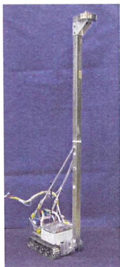
写真2 作製したくい打機模型
