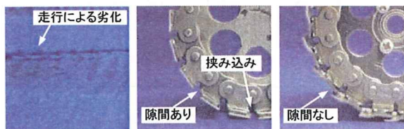
(a) 走行後模型地盤 (b) 改良前履帯 (c) 改良後履帯 写真3 履帯形状と模型地盤劣化
