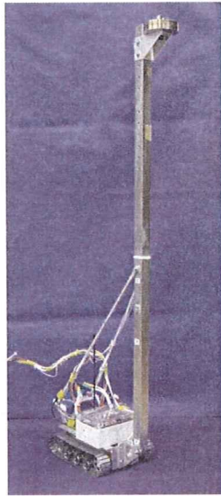
写真3 作製したくい打機械模型
