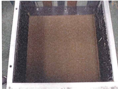
写真 7-3-4 締固め終了後の模型地盤
