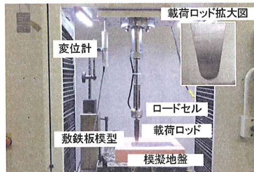
写真 7-3-1 支持力実験概念図
