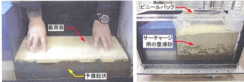
写真 5-4-15 予備起伏を与えた後の載荷板による再載荷とサーチャージ用の準備
