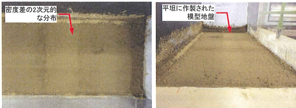
写真 5-4-10 2次元的な密度分布が再現されたFU地盤
