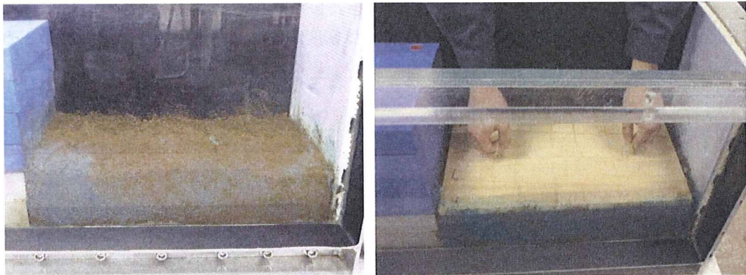
写真 5-4-11 試料を投入と載荷板による予備荷重の様子
