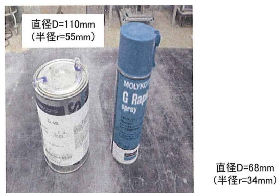
写真 5-4-12 予備起伏の作製に用いた2つの円筒
