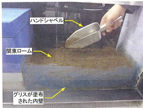
写真 5-4-4 走行ボックスに試料を投入した様子
