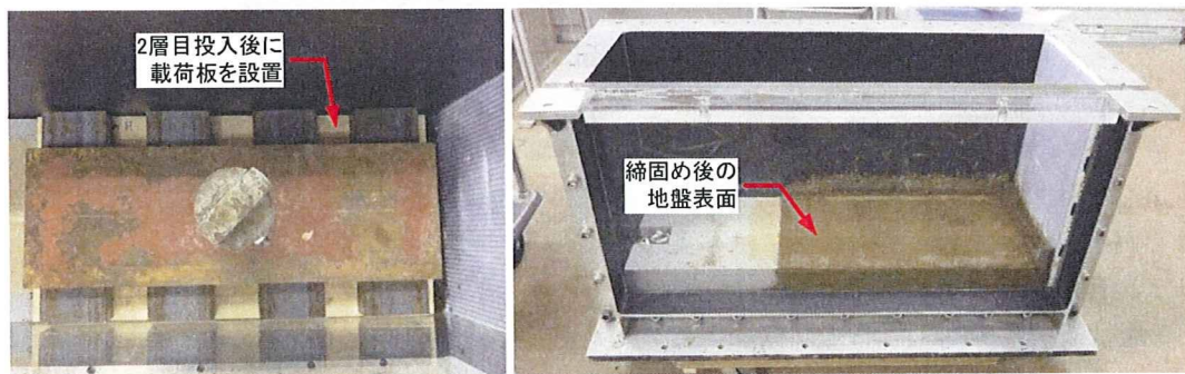
写真 5-4-9 2層目投入後の締固め
