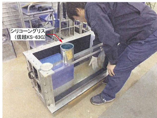
写真 5-4-2 走行ボックスの内壁にグリスを塗布する様子
