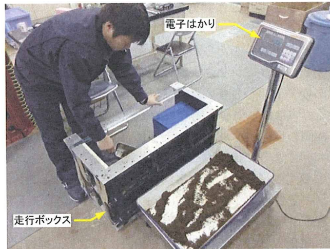
写真 5-4-3 分量をあらかじめ調整した関東ロームを走行ボックスに投入する様子
