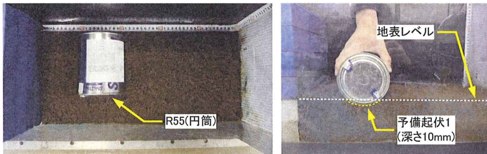
写真5-4-13 地盤表面に予備起伏1を与える様子
