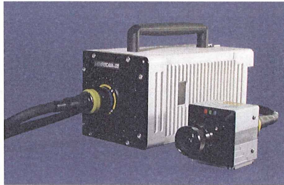
写真 5-3-3 遠心模型実験に使用した高速度ビデオカメラ (MEMRECAM fx RX-6) の外観
