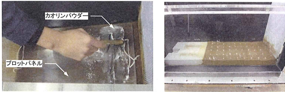
写真 5-3-14 模型地盤に対する試験位置のマーキング(左: マーキングの様子, 右: 完成後)
