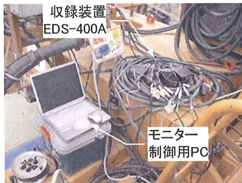
写真 4-5-5 上部旋回体に配置した計測装置
