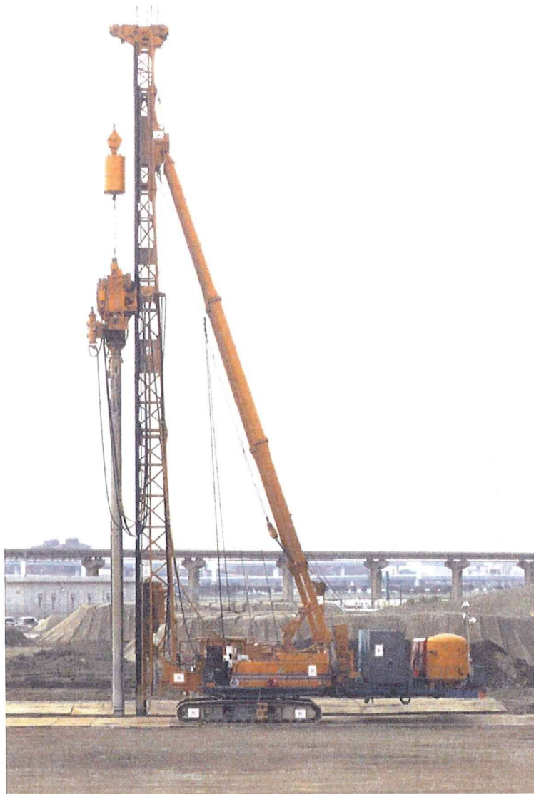
写真 4-5-1 自走実験に使用したくい打機械の外観
