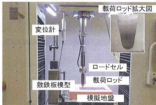
写真 2-2-6 敷鉄板模型に対する異なる位置の載荷実験の様子
