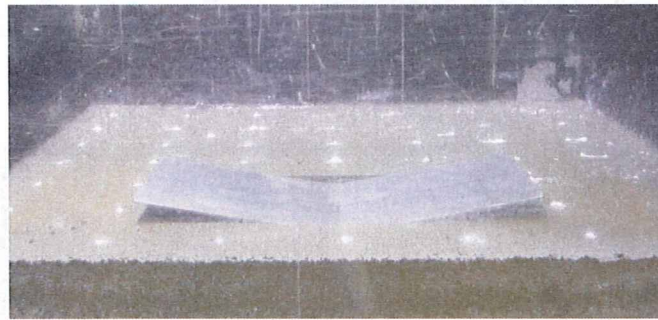
写真 5-3-17 中央載荷後の敷鉄板模型の様子
