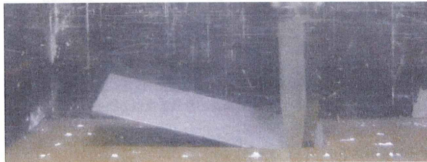
写真 5-3-20 偏心量載荷後の地盤の様子
