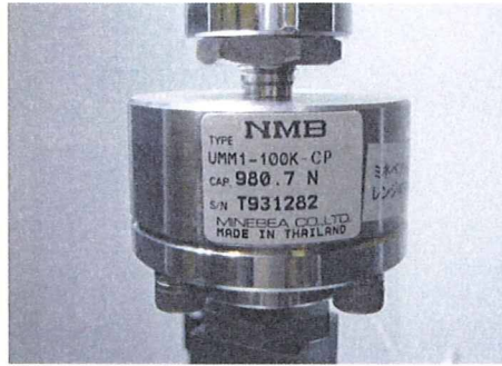
写真 5-2-2 ミネベア製ロードセル (UMM-1-100K-CP)
