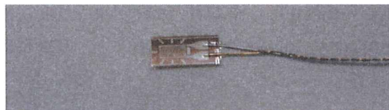
写真 5-3-3 ひずみゲージ先端部
