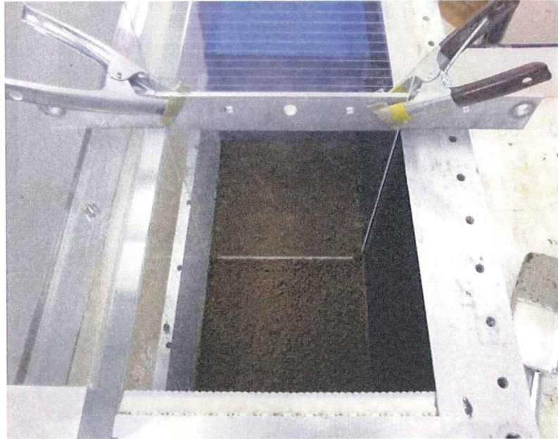
写真 4-14-1 地盤作製の様子
