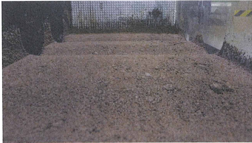
写真 4-13-1 遠心载荷前の模型地盤
