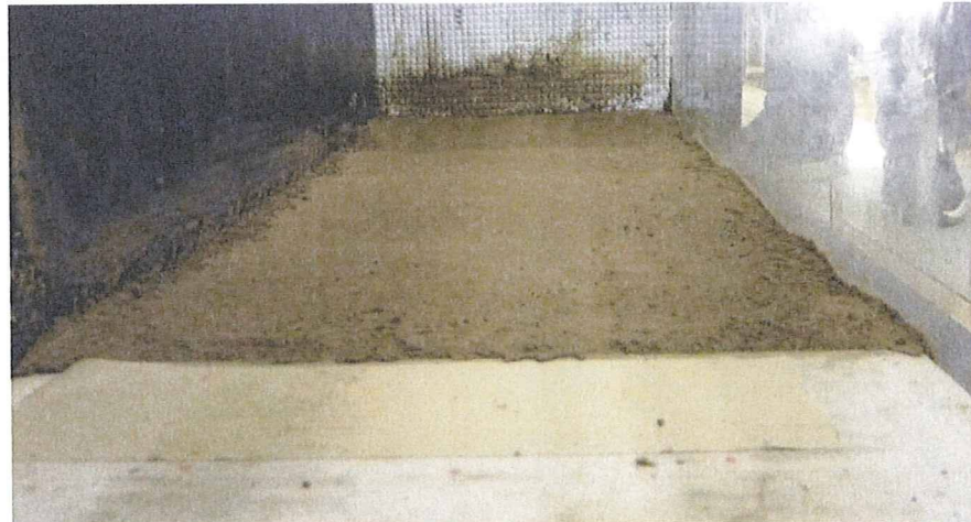
写真 4-13-2 遠心载荷後の模型地盤
