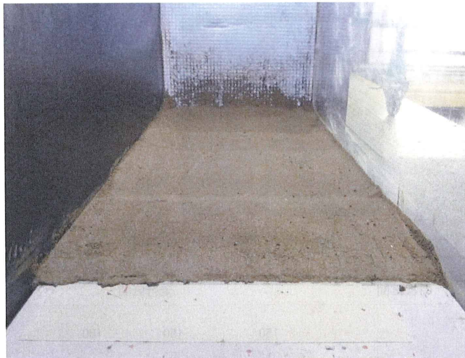
写真 4-10-3 遠心載荷終了後の地盤
