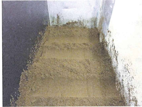
写真 4-10-2 円筒缶を貫入させた地盤
