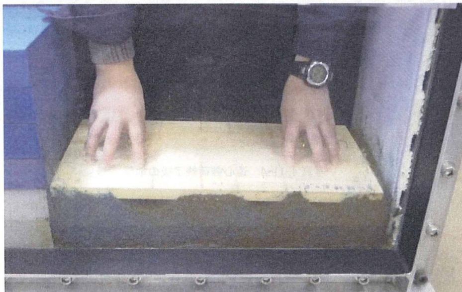
写真 4-11-2 木板で地表面を締め固める
