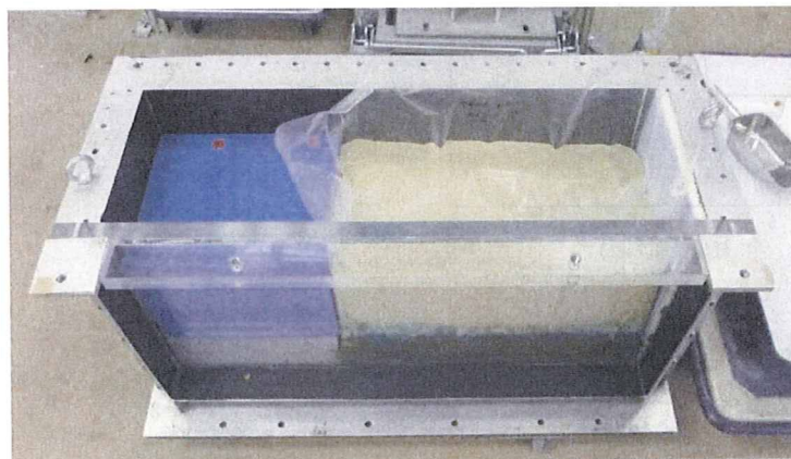
写真 4-9-2 土被り用の豊浦砂を設置
