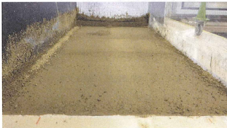
写真 4-7-2 載荷終了直後の模型地盤
