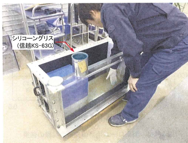
写真 3-4-2 走行ボックスの内壁にグリスを塗布する様子
