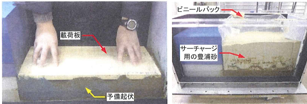
写真 3-4-15 予備起伏を与えた後の载荷板による再载荷とサーチャージ用の準備
