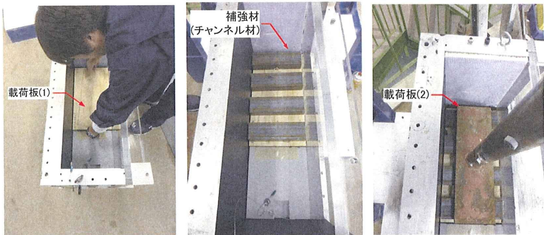
写真 3-4-6 載荷板を設置して地盤を静的に圧縮する様子
