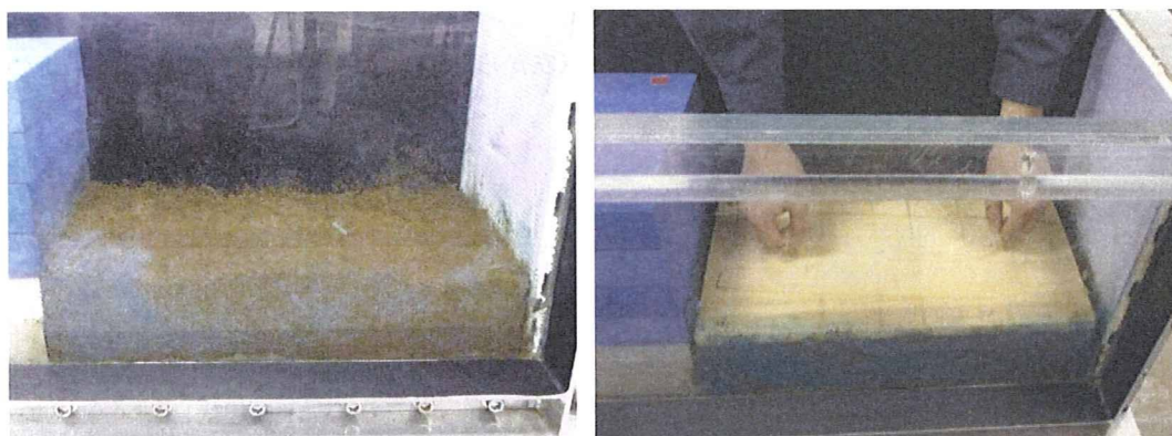
写真 3-4-11 試料を投入と載荷板による予備载荷の様子
