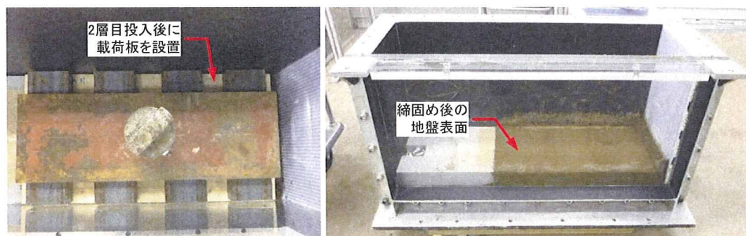
写真3-4-9 2層目投入後の締固め
