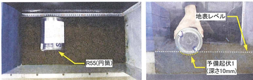
写真 3-4-13 地盤表面に予備起伏 1 を与える様子
