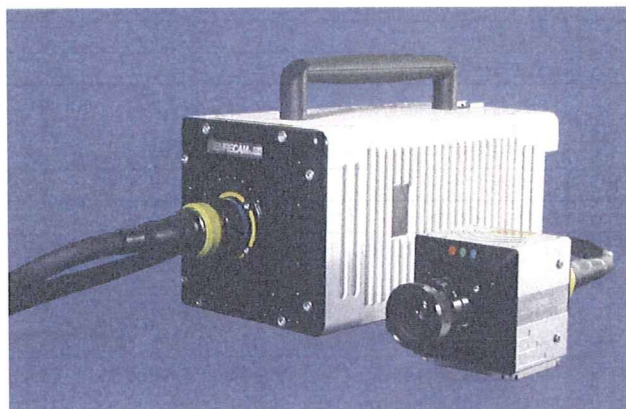
写真 3-3-3 遠心模型実験に使用した高速度ビデオカメラ (MEMRECAM fx RX-6) の外観
