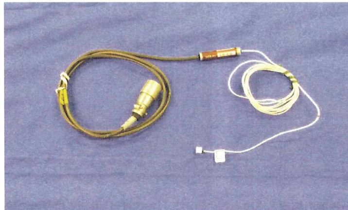
写真 3-3-16 エスエスケイ(SSK)製の超小型加速度計(A6H-100)の外観
