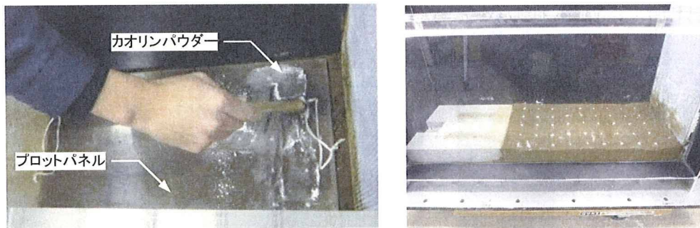
写真 3-3-14 模型地盤に対する試験位置のマーキング(左: マーキングの様子, 右: 完成後)
