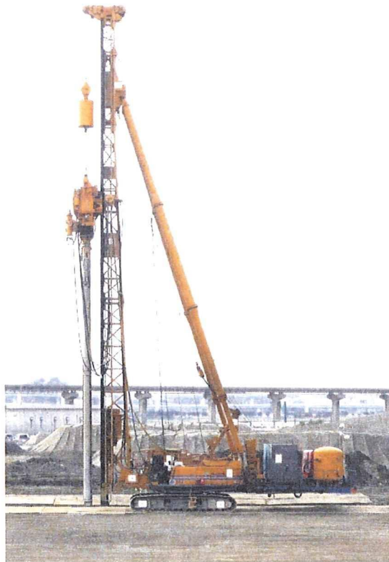
写真 3-2-2 実大走行実験に用いたくい打機の外観
