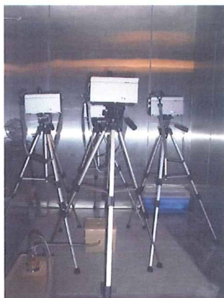
図 6.5 デジタル粉じん計の測定状況図
