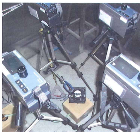
図 6.7 発生源上部にファンを設置した状況
