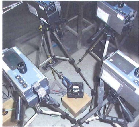
図 6.7 発生源上部にファンを設置した状況
