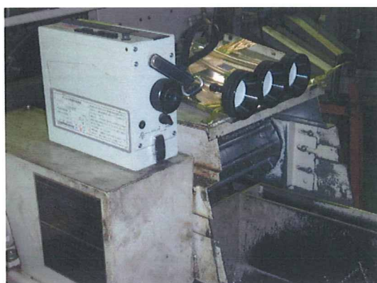
図 4.16 オープンフェイス型サンプラーを用いた測定の様子
