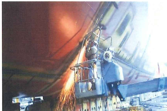
図 3.18 接合部における研ま作業の様子
