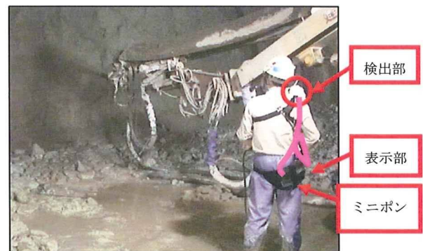
図 1.23 改良型 PDS-2 による作業者の粉じん曝露濃度測定状況
