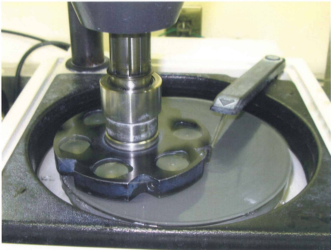
図5 Ecomet 3研磨器による試料の研磨
