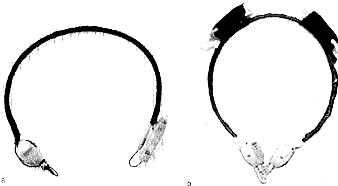
図3 ヘアーバンド式骨導補聴器 aは通常の骨導補聴器。bは両側骨導補聴器。
