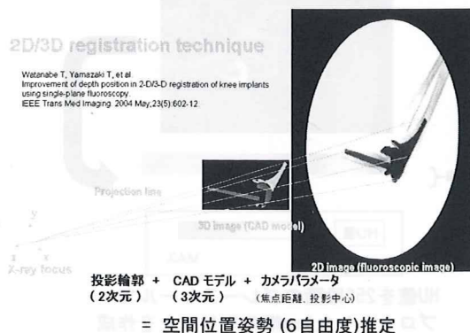
図5. 2D/3D レジストレーション法による人工肘関節の生体内動態解析
