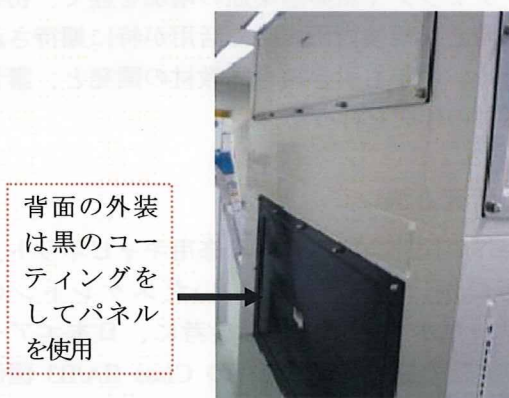
図4. クラスII生物学用安全キャビネットの 改良部分（背面）
