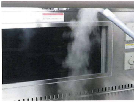
図5. クラス I 生物学用安全キャビネット内での気流のデモンストレーション例
