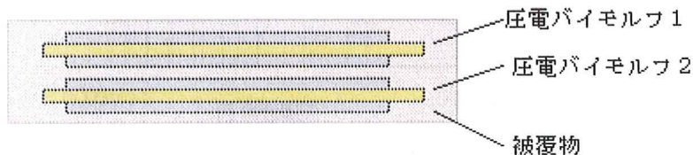
図3 圧電バイモルフ 2 枚構成型 (側面図)
