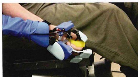
図 3：四肢麻痺者による動作試験 (上) 手を開いた状態 (下) 手を閉じた状態
