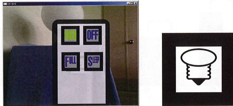
図2 ARによる照明操作パネルの表示例(左)とAR マーカー(右)
